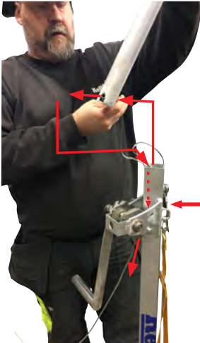
Vedä vaijeri ulos ja asenna se teleskooppiputken läpi
