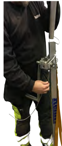
Vedä uutta vaijeria ulos samalla, kun työntät teleskooppiputkea sisään.
