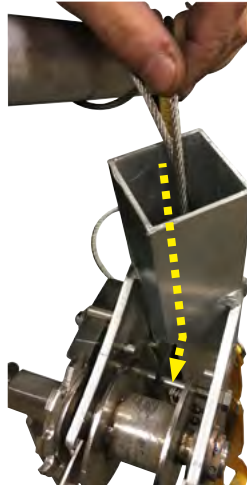
ja sitten takaisin putken ja ulos kampeen toisella puolella olevan raon kautta.
